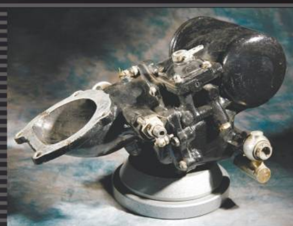
Карбюратор К-105, устанавливавшийся на двигатели самолетов Пе-2, Як-4. Музей «ОДК-СТАР».
