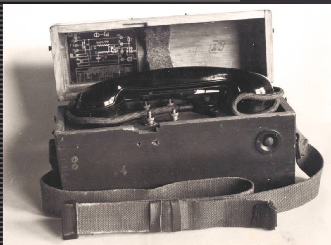
Телефонный аппарат УНФ 1941 г., производившийся на заводе №629. Фотографии из личного альбома работника завода «Телта» А.С. Горкунова.
